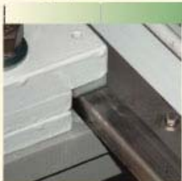
Protezioni in acciaio inox per parti scorrevoli
