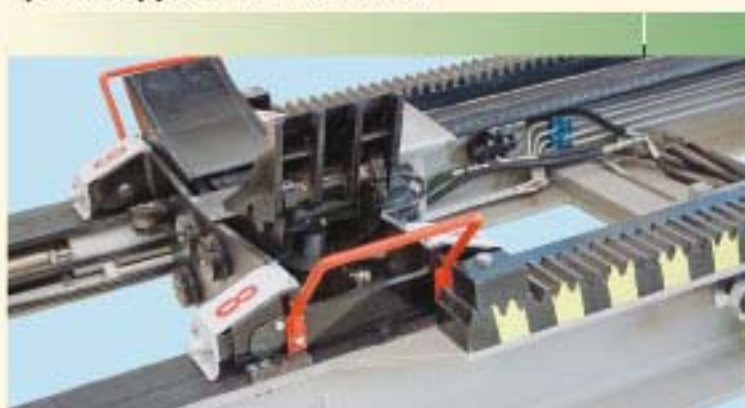
Supporti idraulici servoassistiti per il supporto dei diaframmi
