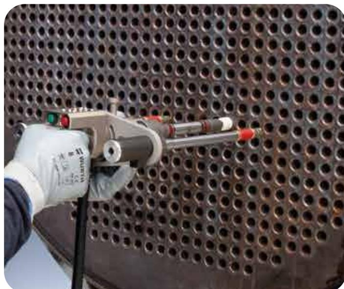
Questo dispositivo elimina la "crevice corrosion" e le cricche nella saldatura
