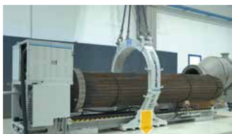
Svincolo del mantello e deposito a terra tramite gru 6
