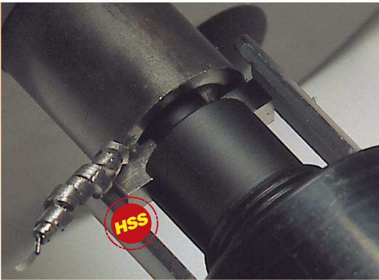
L'**F/751R**, con taglio a destra, è utilizzata, dopo la mandrinatura, per intestare i tubi della seconda piastra alla stessa sporgenza (adatta anche per la rifinitura). La campana rotante preserva la superficie della piastra tubiera dai segni di lavorazione.
