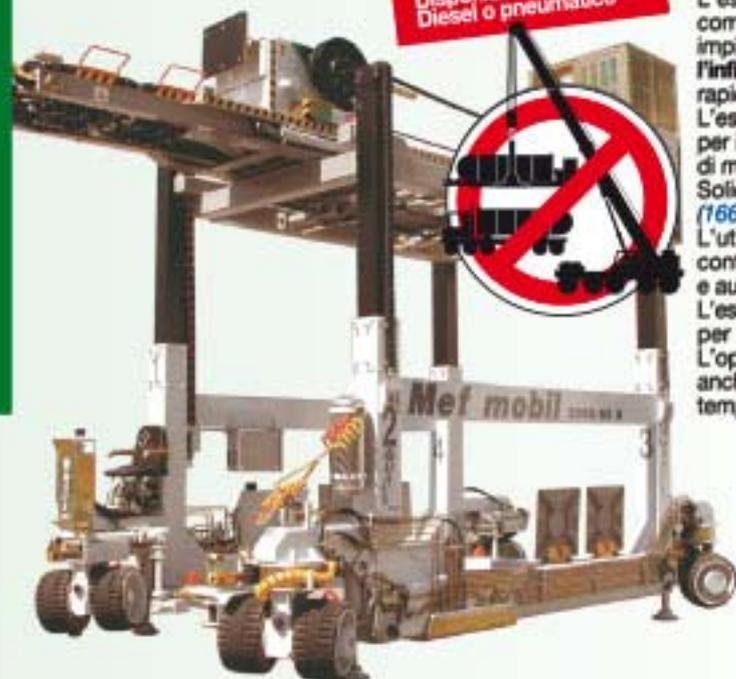
L'estrattore di fasci tubieri **Mef mobil**, studiato per accessi difficili, completamente **autosufficiente**, si impone come soluzione globale negli impianti petrolchimici per l'estrazione di fasci tubieri. Per l'estrazione e l'infilaggio del fascio si utilizza lo sperimentato e veloce sistema ad aggancio rapido del **Mef express**.
