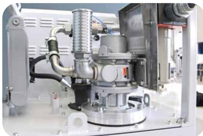
Filtro olio idraulico con indicatore meccanico per
